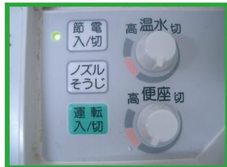
(温水洗浄便座操作盤)
